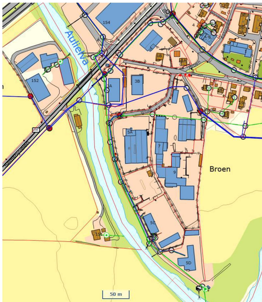
Figur 13: Vann- og spillvannsledninger innenfor planområdet.
