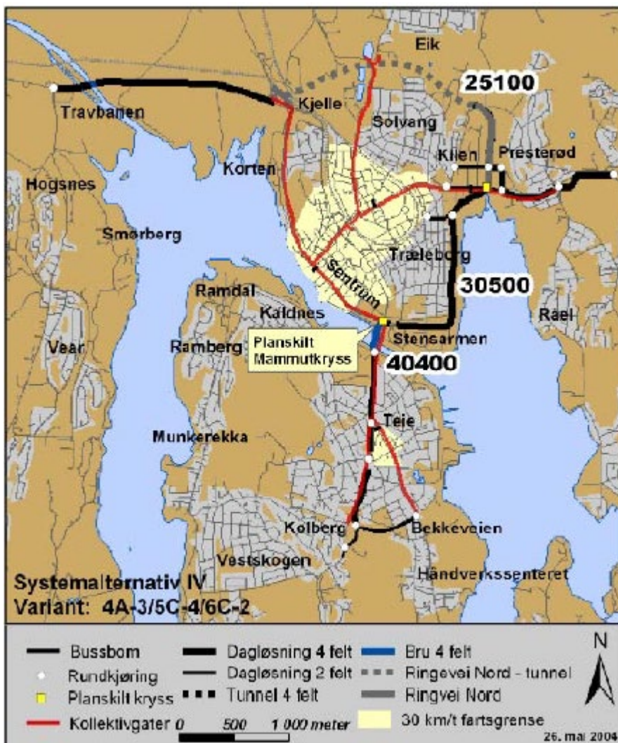
Figur 16: Bru over Kanalen med planskilt Mammutkryss, utvidelse av Ringvei syd til 4 felt fra Mammutkrysset til Kilen og utvidelse av Semslinna til 4 felt til Travbanen. Teieløsning med tverrforbindelse i Bekkeveien og 4-felts Kirkevei med kort miljøtunnel på Teiehøyden. Presterødløsning hvor Presterødløsning utvides fra 2 til 4 kjørefelt og to kollektivfelt. Planskilt kryss på Kilen. Ringvei syd gis tilknytning til Slagenveien via Svelvikgaten.
