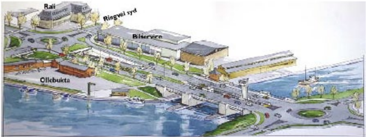
Figur 17: Ringvei syd i 4 felt over Kanalen. Planskilt Mammutkrysset sett mot nordøst.
