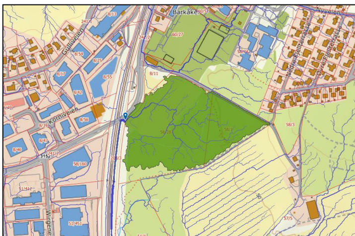
Figur 21 Totalt nedbørfelt for flomvei markert ned grønt
