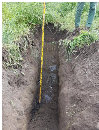
Figur 3: Bilder. Venstre - graving av prøvehull for etablering av overflateinfiltrasjon, høyre - sjakting av prøvehull
