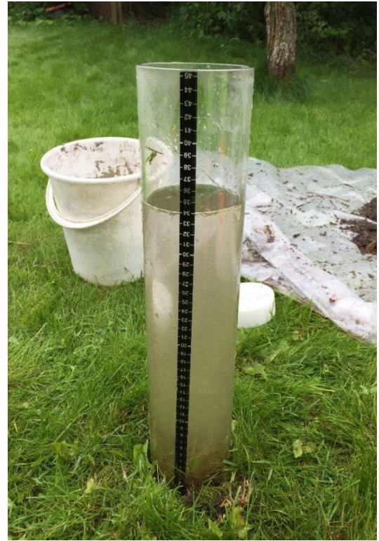
Figur 6: Bilde. Måling av infiltrasjonskapasitet på en grasdekt overflate (overflateinfiltrasjon) med bruk av dobbeltring infiltrometer (venstre) og MPD-rør (høyre). (Foto: Bent Braskerud).
