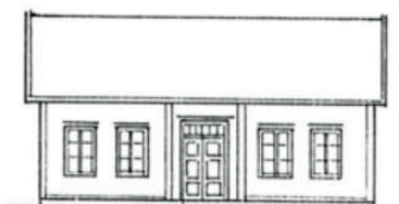
1830 Tilbygg. Panel med novkasser Empire-vinduer
