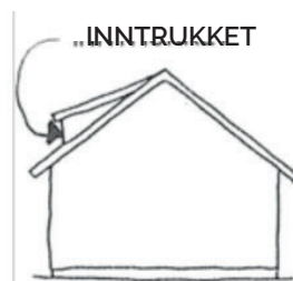
Oppløft inntrukket fra gesims
