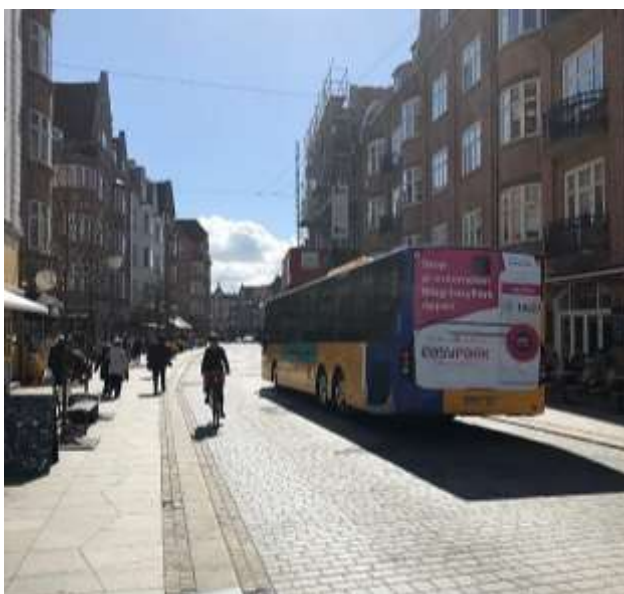
Figur 6-10: Bildet er fra en sentrumsgate i Ålborg hvor buss og sykkel deler gatetverrsnitt. Denne løsningen kan være aktuell å vurdere i Nedre Langgate hvor bussen og sykkel passerer det mest sentrale av Tønsberg, gatetverrsnittet er smalt og hvor det i all hovedsak er busser som passerer (foto: Nina Ambro Knutsen).
