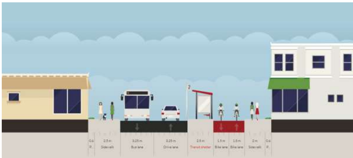
Figur 6-4: Typisk gatetverrsnitt på hovedaksene inn mot sentrum: Ved busstopp føres sykkelveien med fortau bak leskuret, for å unngå konflikter med av- og påstigende og ventende busspassasjerer.
