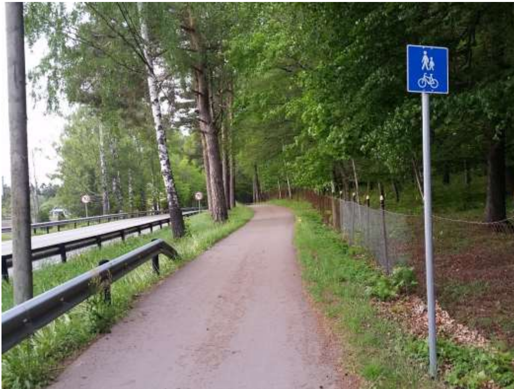
Figur 6-7: Sykkelvei med fortau. Denne løsningen er valgt som hovedløsning for sykkel og gange langs alle hovedaksene, med noen unntak (foto: Knut Opeide, Statens vegvesen).
