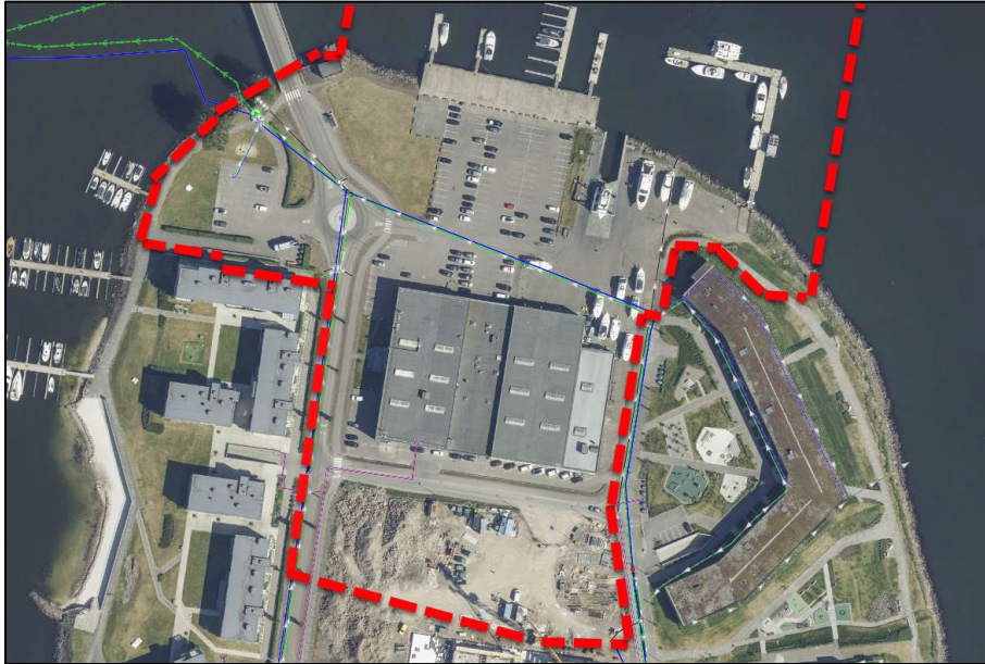
Eksisterende vann- og avløpsledninger Jarlsø Nord.
