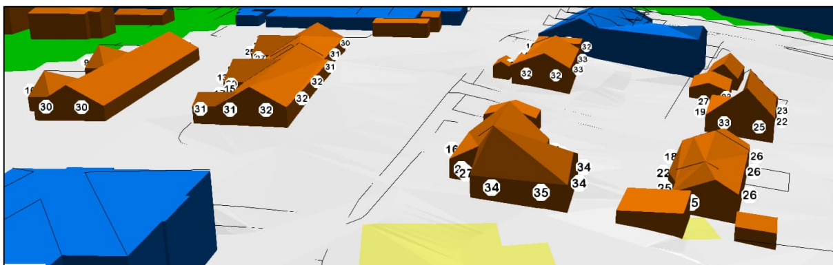
Figur 7 Fasadenivåer inkl. refleksjon ved nærmeste naboer til planområdet. Beregnet for grenseverdi natt (LAF Max = 35 dB). Sett fra nord.
