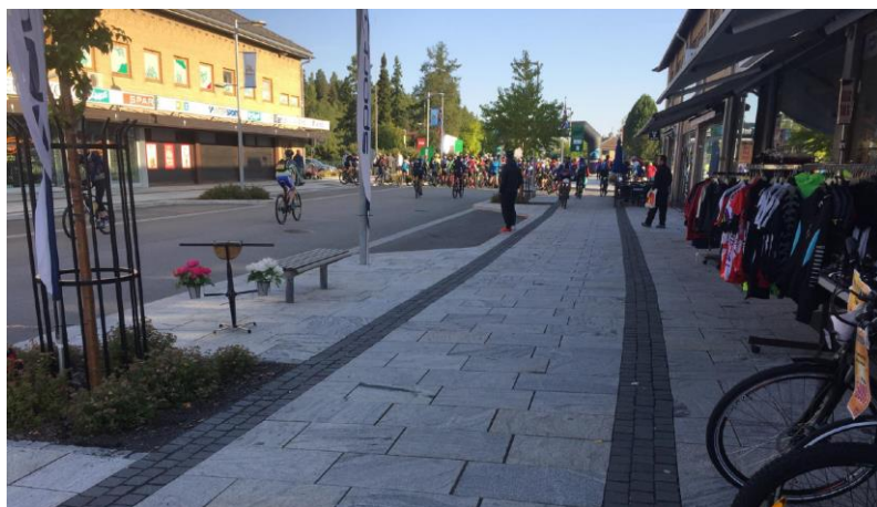
Eksempel på gangzone fri for hindringer og med taktil og visuell avgrensning. Foto: Universell utforming AS
