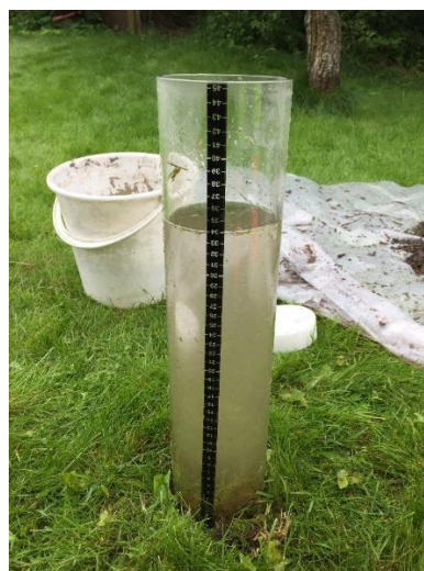
Figur 6: Bilde. Måling av infiltrasjonskapasitet på en grasdekt overflate (overflateinfiltrasjon) med bruk av dobbeltring infiltrometer (venstre) og MPD-rør (høyre). (Foto: Bent Braskerud).
