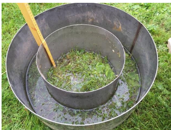
Figur 6: Bilde. Måling av infiltrasjonskapasitet på en grasdekt overflate (overflateinfiltrasjon) med bruk av dobbeltring infiltrometer (venstre) og MPD-rør (høyre). (Foto: Bent Braskerud).
