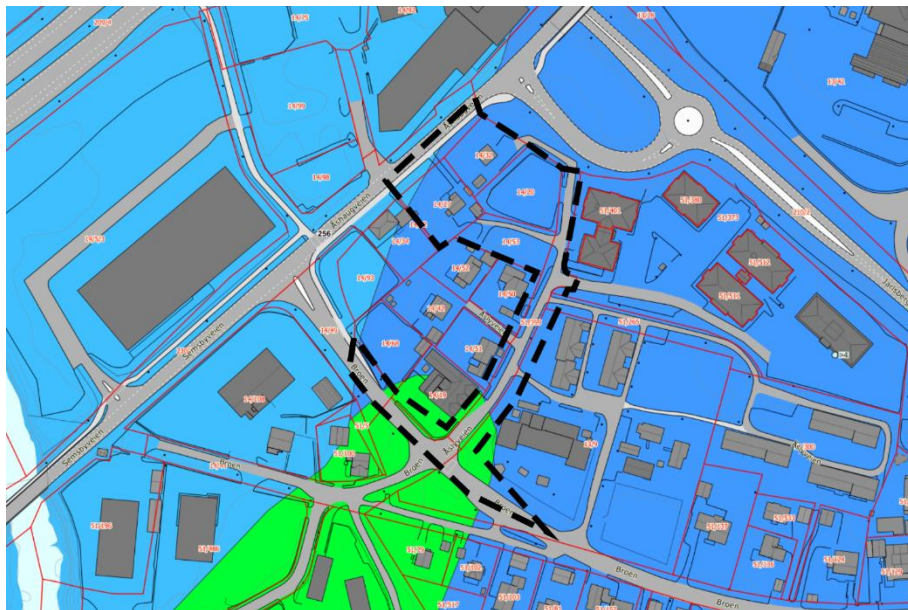
Figur 4.3: Løsmassekart med varslet planavgrensning markert med svart stiplet linje. Utklipp fra NGU – Løsmassekart.
