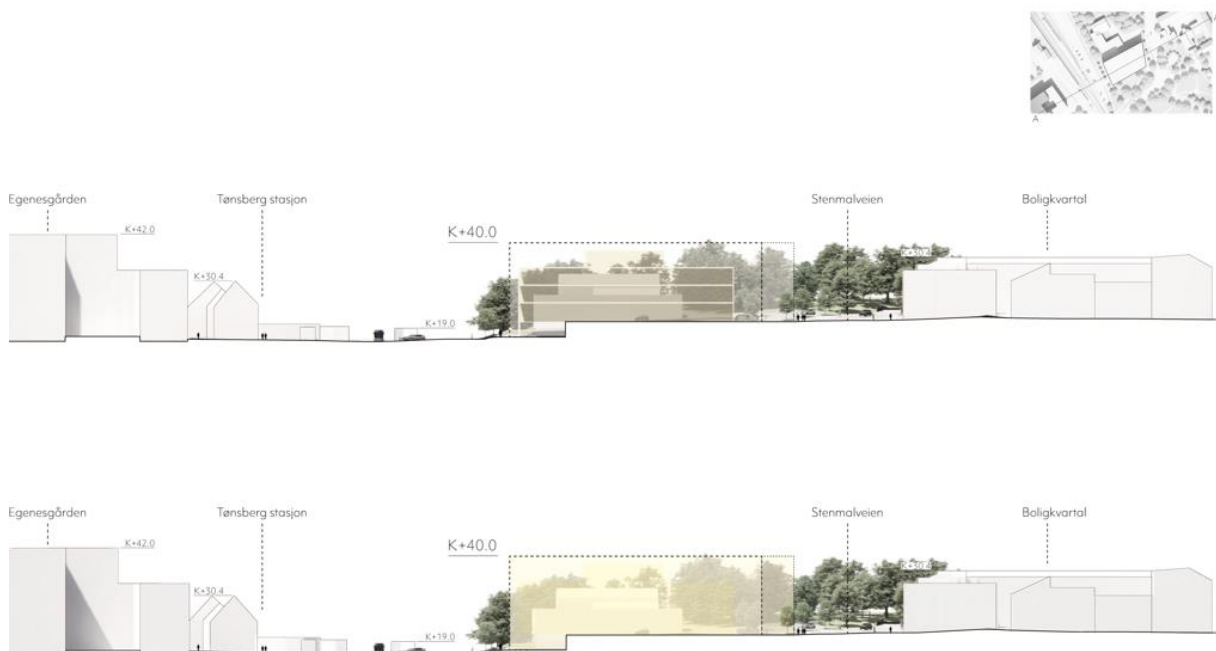
Figur 4-5: Snitt viser transparent, gult volum med stiplet linje som maks byggegrense/høyde. Bestemmelsene tillater opp til 4 etasjer og en tilbaketrukket toppetasje, med en øvre gesims på K+40 m.
