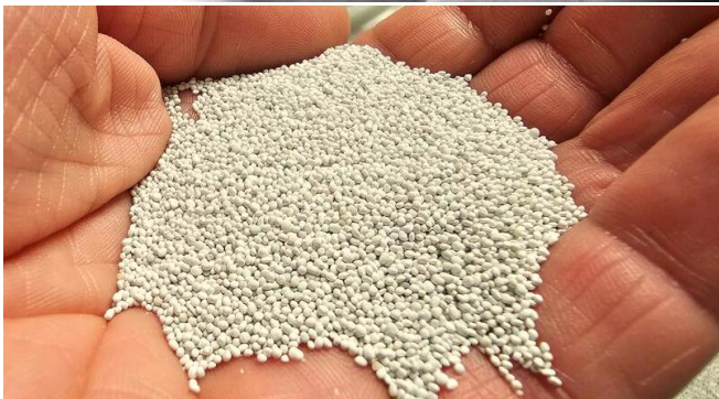
Figur 19. Fra avløpsvann til gjødselressurs. Ved HIAS på Hamar gjenvinnes fosfor fra avløpsvann som struvitt, et fosforrikt produkt som kan brukes som gjødsel der det trengs (bilde ovenfor). VEAS i Oslo gjenvinner nitrogen fra avløpsvann som ammoniumsulfat, som brukes som innsatsfaktor i produksjonen av gjødsel. Eksemplene viser hvordan valg av teknologi ved renseanleggene kan bidra til at nitrogen og fosfor fra maten vi spiser tilbakeføres til jordbruket i former som kan utnyttes av plantene, framfor at næringsstoffene går tapt.
