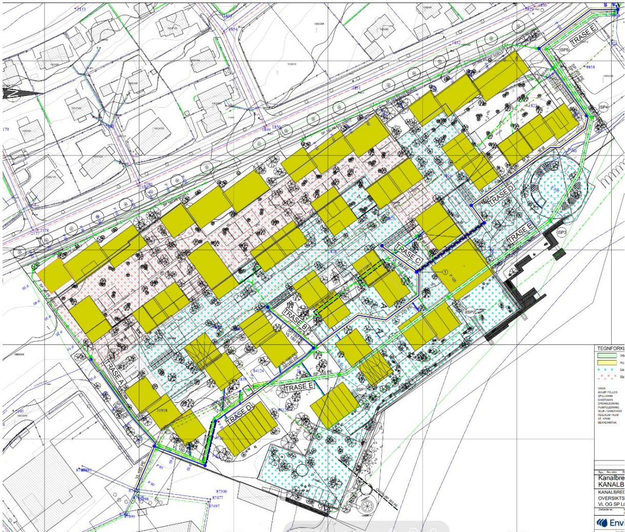
Figur 12 — VA-plan (Utklipp fra tegning H2.01)
