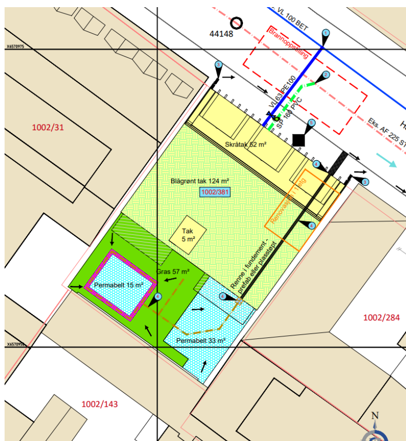
Figur 15 Planutsnitt fra kommunalteknisk plan, som beskriver overvannshåndteringen
