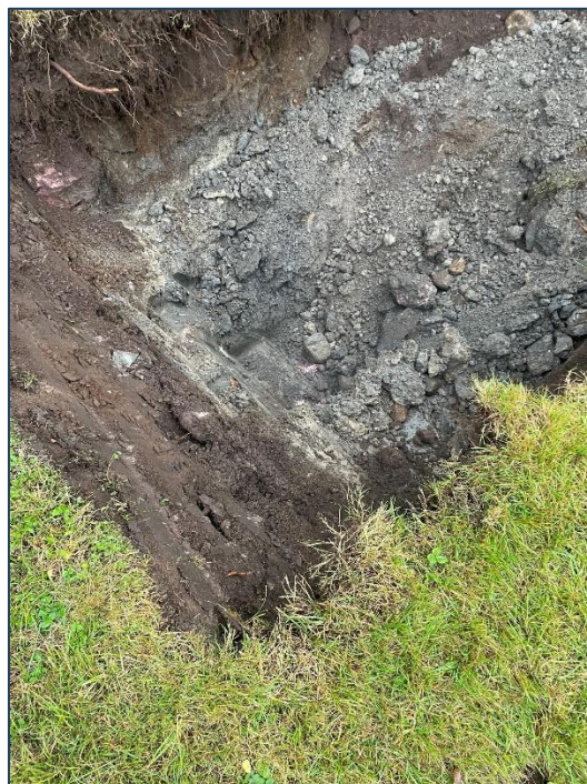
Figur 6: I B4 til venstre var det noe fyllmasser i form av sprengt berg i toppen der terrenget stiger mot sør. Berg ble påtruffet i 3,5 meters dybde. I B3 til høyre ble berg påtruffet i 1,8 meters dybde. Foruten fyllmassene var det høyt innslag av humus øverste 0,5-1 meter deretter sand og leire med minerals preg.
