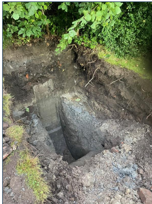
Figur 5: B1 til venstre og B2 til høyre. Begge prøvegravingene viser et sandig humusholdig jordlag øverste 0,5-1 meter og deretter sandig materiale over fast leire.
