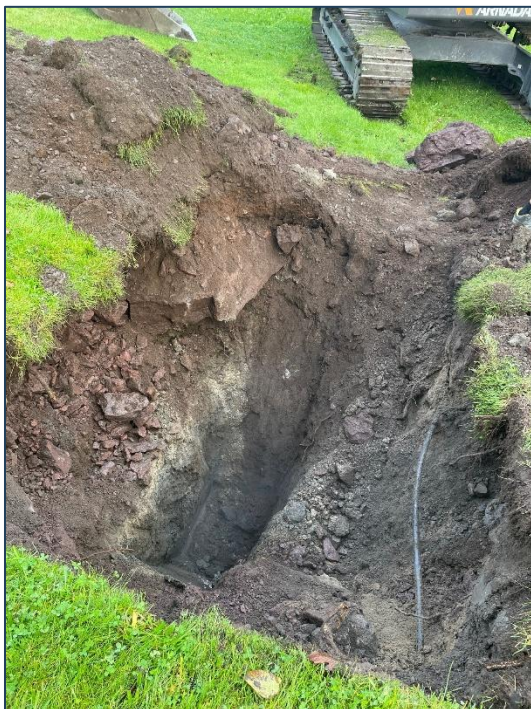
Figur 6: I B4 til venstre var det noe fyllmasser i form av sprengt berg i toppen der terrenget stiger mot sør. Berg ble påtruffet i 3,5 meters dybde. I B3 til høyre ble berg påtruffet i 1,8 meters dybde. Foruten fyllmassene var det høyt innslag av humus øverste 0,5-1 meter deretter sand og leire med minerals preg.
