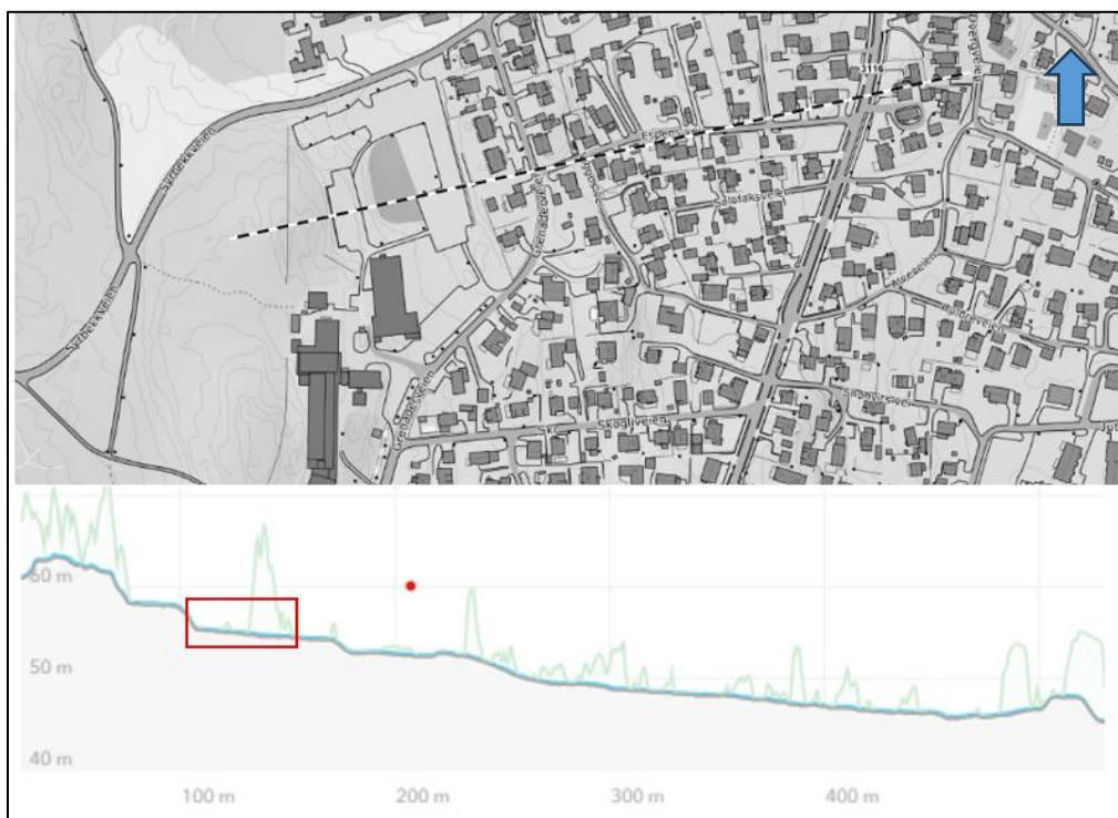
Figur 11: Representativt terrengprofil er vist ovenfor med slakt hellende terreng 1:40 mot øst.
