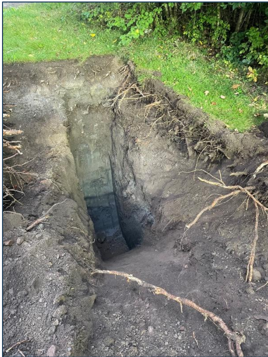
Figur 5: B1 til venstre og B2 til høyre. Begge prøvegravingene viser et sandig humusholdig jordlag øverste 0,5-1 meter og deretter sandig materiale over fast leire.
