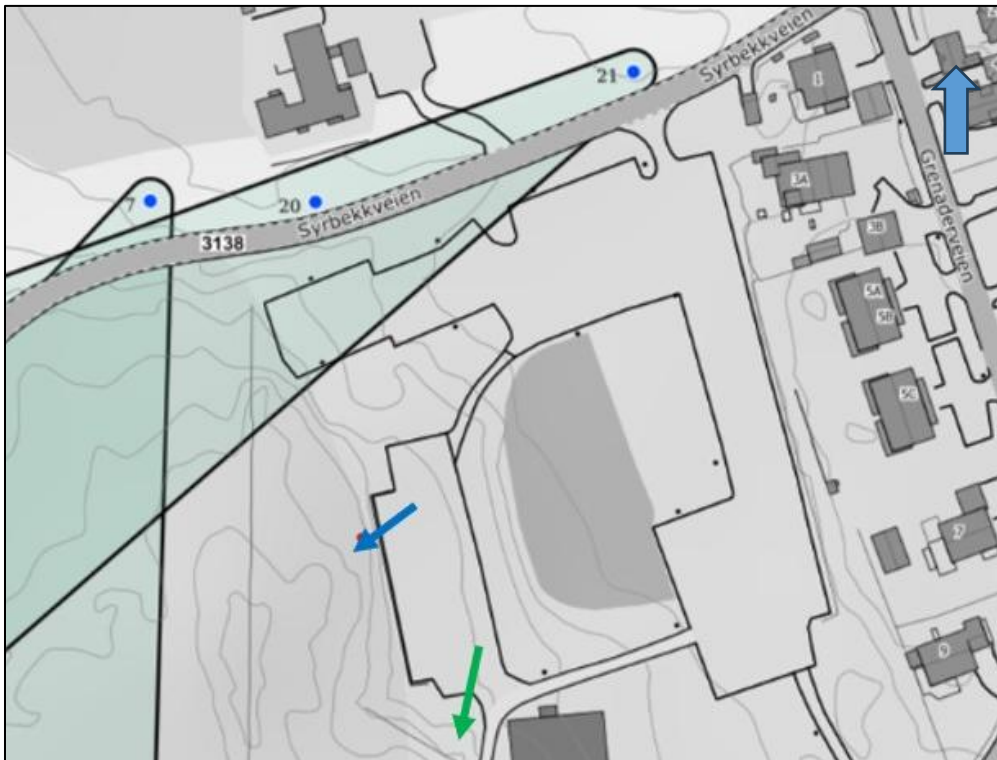
Figur 7: Utsnitt fra NADAG som viser 3 utførte boringer nord for utbyggingsområdet. Boring 7 og 20 var begge grunne på ca. 2 meter og boring 21 viste løsmasser ned til 7 meter før berg. Blå og grønn pil indikerer posisjon og retning for henholdsvis bilde i Figur 8 og Figur 9.
