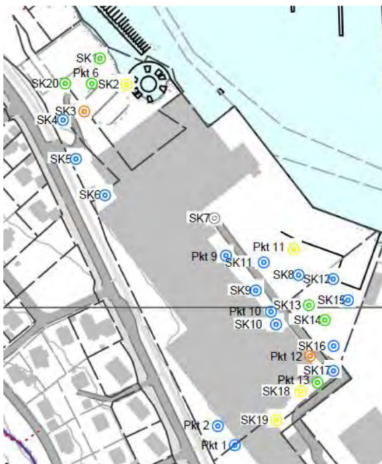
Figur 4: Forurensningsgrad med høyeste påvist forurensning over området. Fargekoder: tilstandsklasse 1 = blå, tilstandsklasse 2 = grønn, tilstandsklasse 3 = gul, tilstandsklasse 4 = oransje. Kilde: Utsnitt fra GrunnTeknikk rapport 114965r2, datert 6.11.2020.
