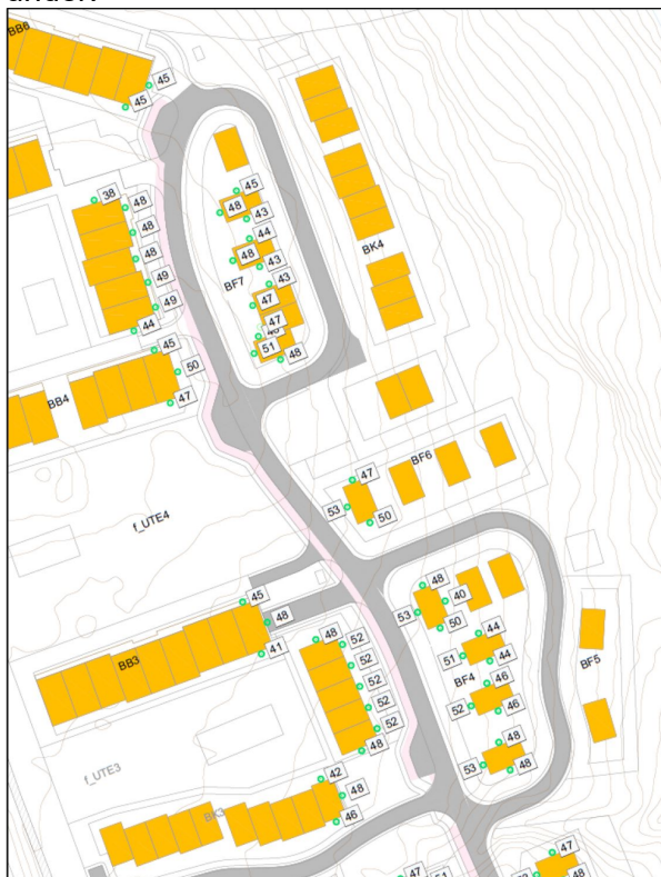
Figur 5-2 Velleskogen - høyeste fasadenivå foran vindusfasader - Nordligste del
