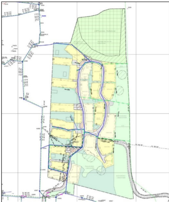
Forslag til nye hovedtraseer i utbyggingsområde. Eksisterende ledninger på hver side, nye hovedledninger med tykkere blå (VL), grønn (SP) og sort (OV) linje og nye stikkledninger med tynnere linje.
