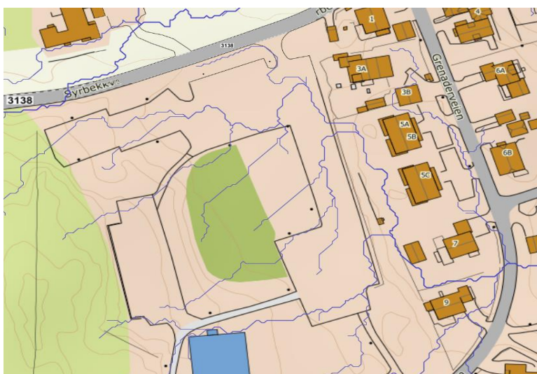
Figur 3: Dreneringskart for overvann fra Scalgo
