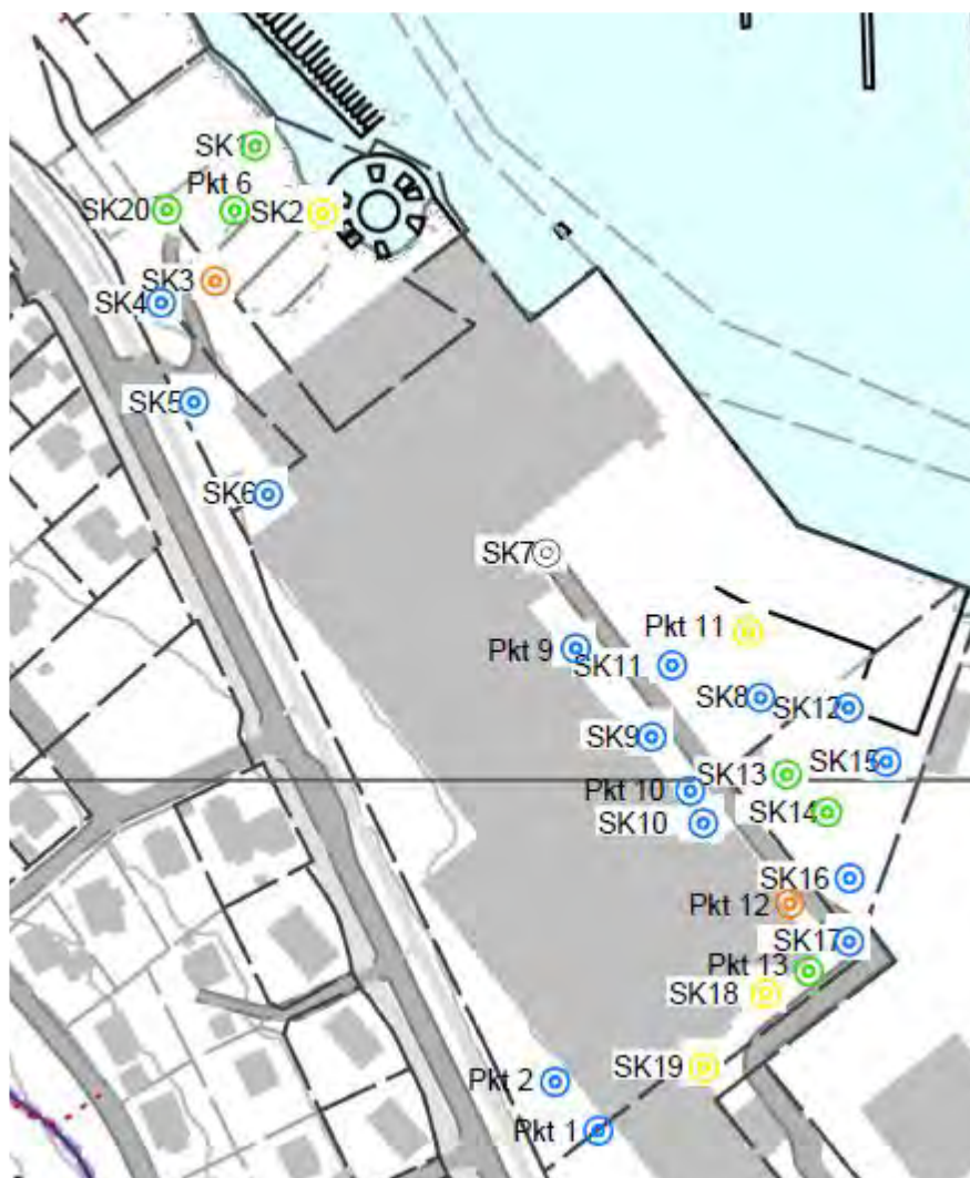
Figur 4: Utsnitt fra tegning 2, Forurensningskart, høyeste påviste tilstandsklasse. Prøvepunkter fra 2018 (prefiks Pkt) er også inkludert her.
