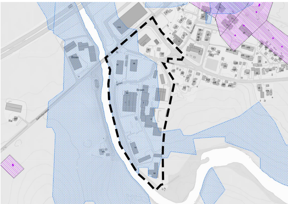
Figur 4.5: Områder for aktsomhet kvikkleireskred (blå skravur) og kvikkleireområder (lilla skravur). Utklipp fra NVE Atlas.
