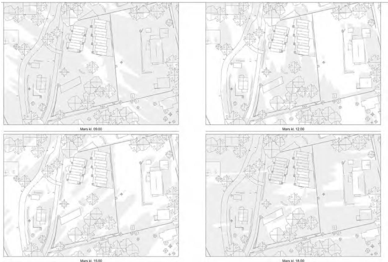
Figur 32 Sol/skyggediagrammer for vår- og høstjevndøgn
