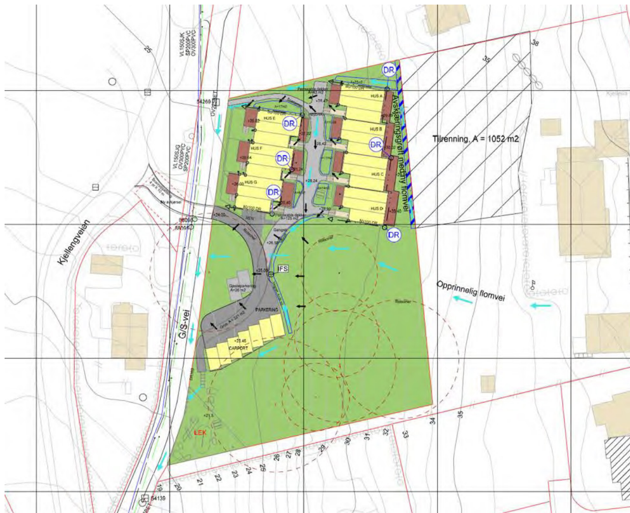
Figur 37 Utsnitt fra plan for overvannshåndtering (Ingeniørservice AS)
